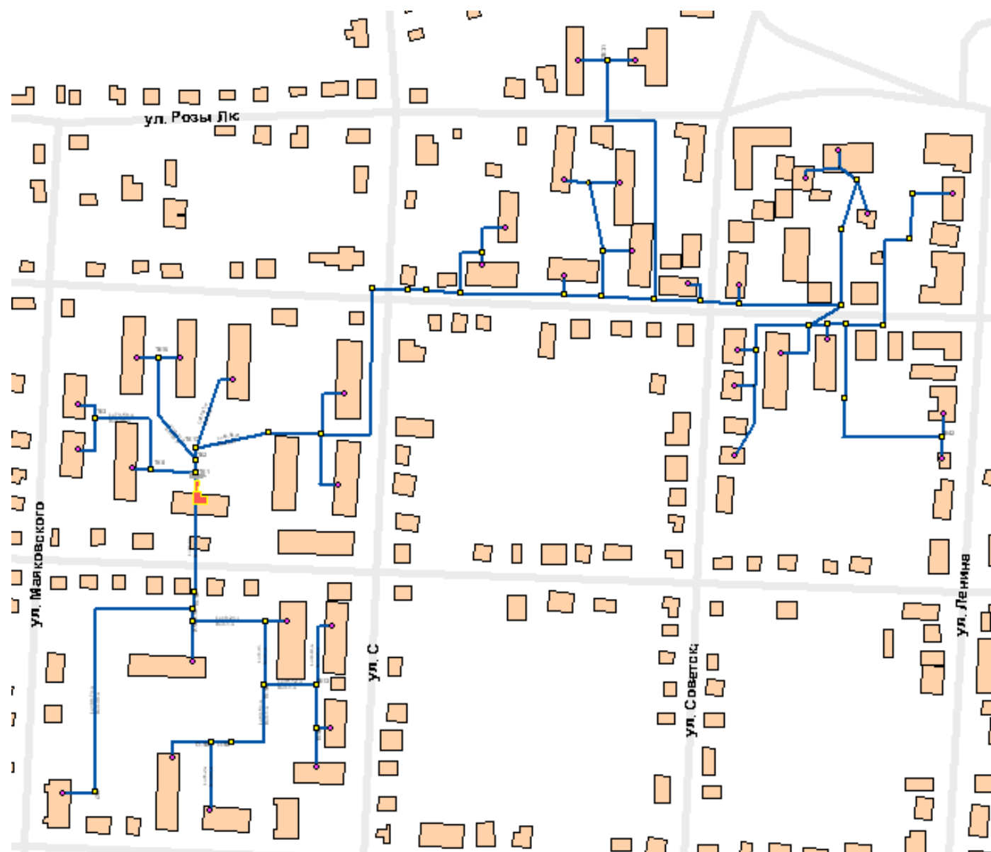
Рис. 3 Схема тепловой сети от котельной №1 «Центральная»
